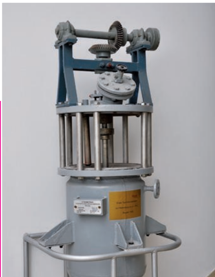
Wacker-Technikumsautoklav zur Herstellung von Suspensions-PVC aus dem Jahr 1936, Burghausen
