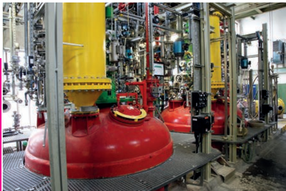
Polymerisationskessel zur Herstellung von Pasten-PVC, Burghausen
